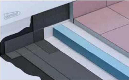
**CUBIERTA CON LÁMINA BITUMINOSA Y PAVIMENTO**
