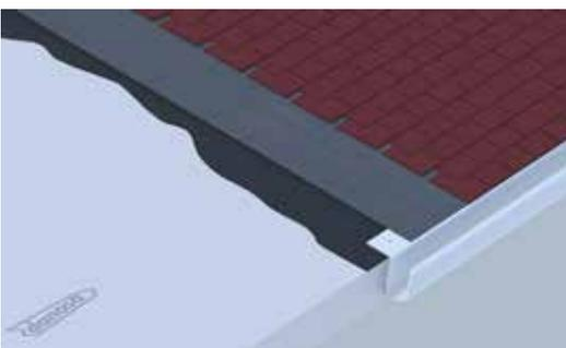
**CUBIERTA INCLINADA CON PLACA ASFÁLTICA**
