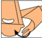
Hacer un orificio de evacuación y colocar la salida universal encajando la pestaña en el rizo.
