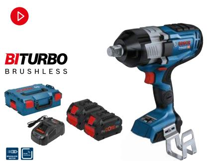
18V. 3/4" cuadrado exterior + fijación con pasador. Pantalla HMI + LED. Par apriete 1.600 Nm / 2.200 Nm desapriete. Máx. 2.350 ipm. 3 ajustes de velocidad 0-800/1.300/1.750 rpm. 2 modos atornillado predeterminados + ajustables. M16-M33. 3,2 kg.
